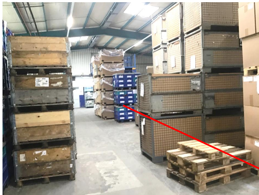
Abbildung 15 Überlastung der Blocklagerfläche Mitte; Die Rote Linie zeigt die eigentliche Grenze des Bereichs auf (Eigene Aufnahme)
