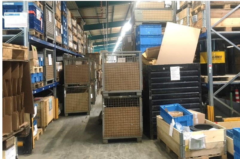
Abbildung 14 Überlastung des Fachregallagers (Eigene Aufnahme)
