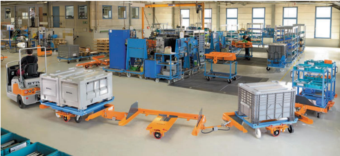
Abbildung 4 Elektroschlepper mit vier einachsigen Einschubanhängern mit E-Rahmen 89
