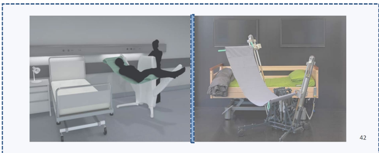
Abbildung 15: Konzept und Prototyp des multifunktionalen Personenlifters „Elevon“ "Elevon"
