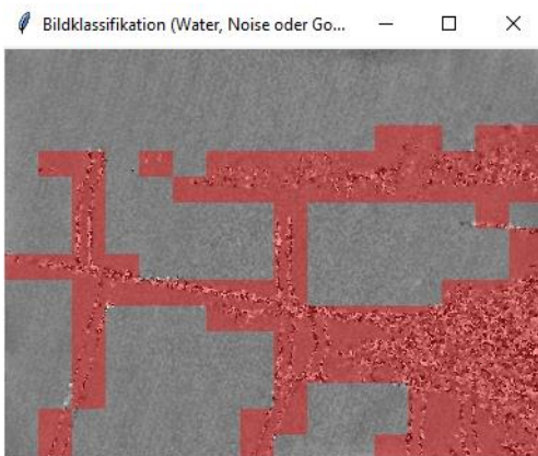
Abbildung 14: Von ResNet50 klassifiziertes Shearographie-Bild (Eigene Darstellung in Anlehnung an SDS, 2024)
