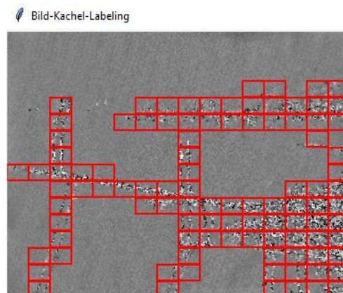
Abbildung 15: Manuell klassifiziertes Shearographie-Bild (Eigene Darstellung in Anlehnung an SDS, 2024)
