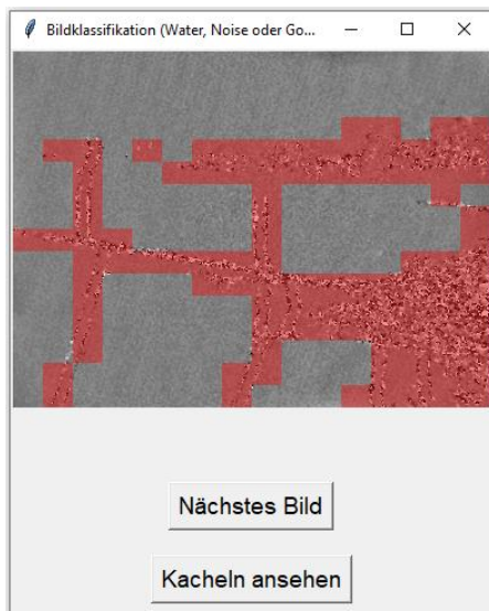
Abbildung 12: Klassifiziertes Shearographie-Bild (Eigene Darstellung in Anlehnung an SDS, 2024)
