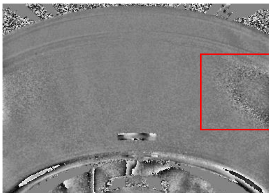
Abbildung 9: Shearographie-Bild des Artefakts "Medium Noise" (Eigene Darstellung in Anlehnung an SDS, 2024)
